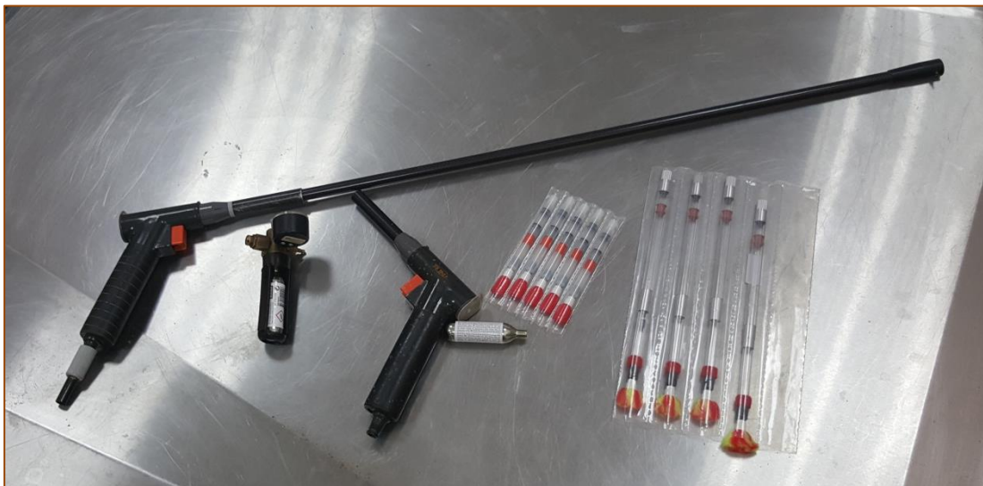
Imagen 2. Cerbatana de aire comprimido y dardos utilizados para el estudio.
